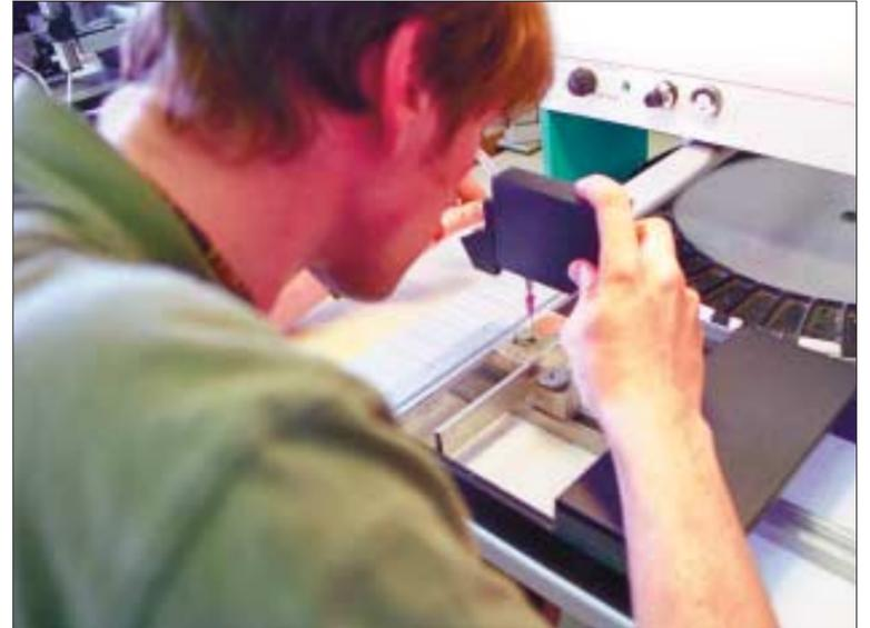
Die Montage der winzigen Bauteile auf die Leiterplatte erfordert eine ruhige Hand. Der Maschinenarm hilft hierbei. Foto: Lars Kühl
