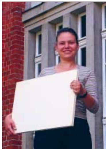
Mit textilen Glasfasern statt mit Stahl bewehrt und nur 20 mm stark – die neue Fassadenplatte. Foto: van Stipriaan
