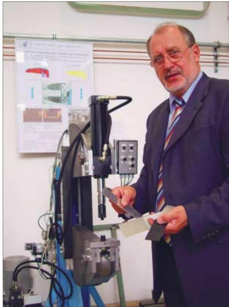
Einer der Patentinhaber an der TU Dresden ist Professor Werner Hufenbach. Gemeinsam mit Dr. Lothar Kroll hat er am Institut für Leichtbau und Kunststofftechnik eine roboterfähige CFK-Leichtbauaufhängevorrichtung mit großem Zangenfenster entwickelt. Damit werden Metallbauteile und Bauteile in Mischbauweise verbunden. Foto: UJ/Eckold
