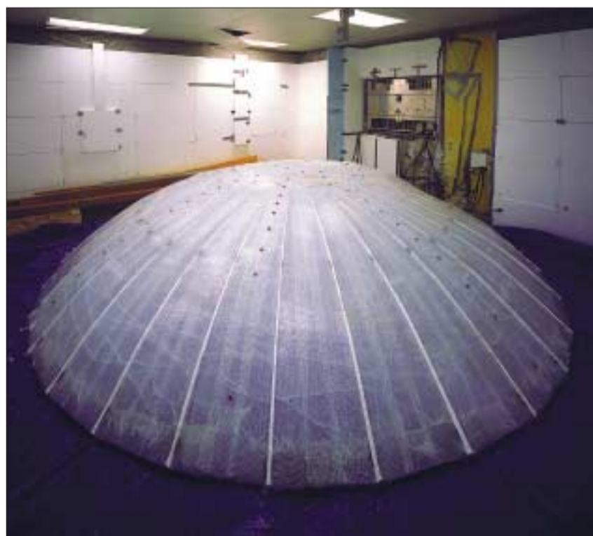
Textilverstärkte Eiskuppel im Kältelabor an der TU Wien.
