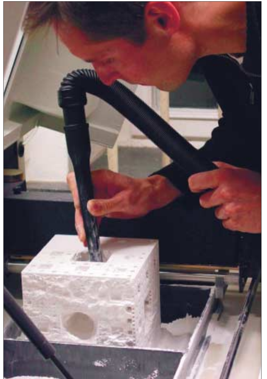
Nach dem Druckprozess muss das Modell aus dem Pulver geborgen werden. Dazu dient unter anderem ein Staubsauger. Frisch »gedruckt« ist das Modell noch relativ empfindlich. Es wird deshalb mit Druckluft gereinigt und mit Epoxidharz infiltriert, wodurch es eine hohe Endfestigkeit erhält. Foto: Karla Nestler
