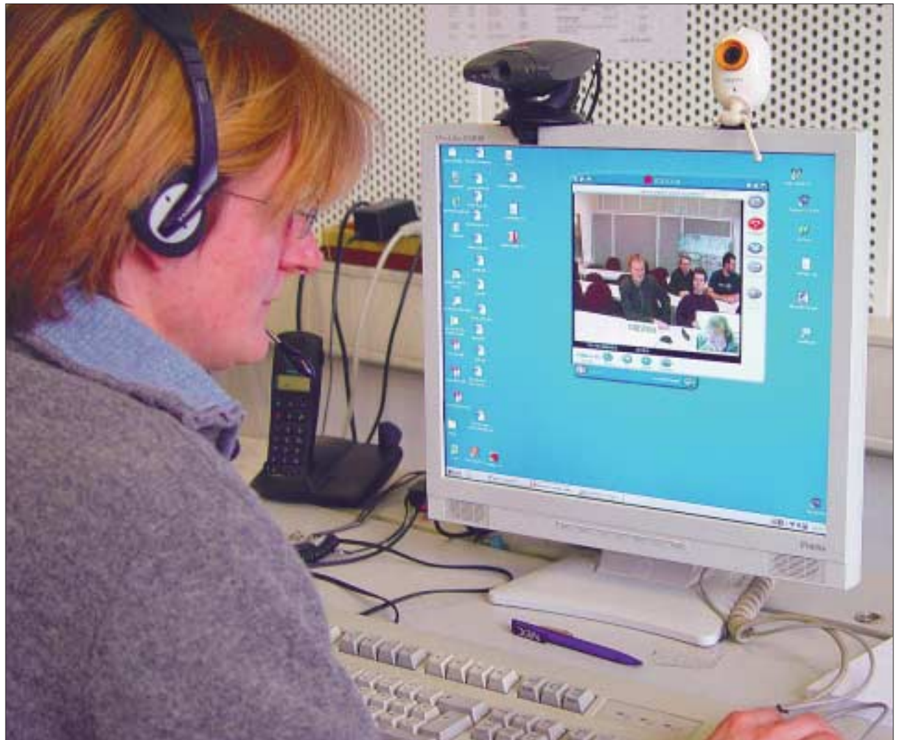
PC-Kamera, das so genannte Head-Set und entsprechende Software machen den PC videokonferenztauglich. Komfortabler tagt es sich mit Videokonferenzsystemen. Welche Hard- und Software sich eignet, weiß das VCC aus zahlreichen Tests. Fotos(2): UJ/Eckold
