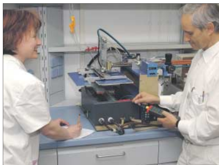
Dr. Gert Richter und Heike Meißner arbeiten an einer Wechseltauchapparatur. Damit werden zahnärztliche Werkstoffe, aus denen z. B. Zahnersatz hergestellt wird, geprüft. Fotos: G. Bellmann
