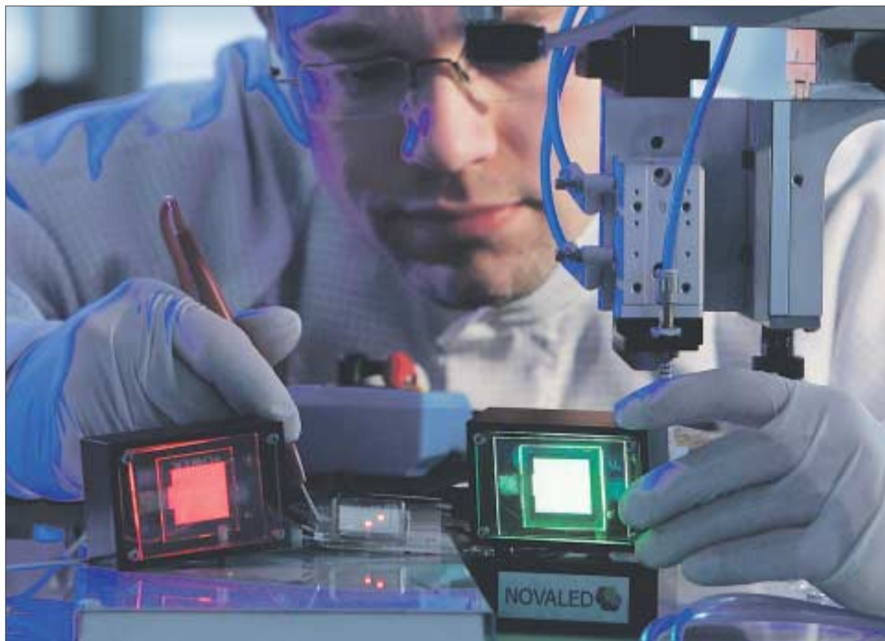
Ein Wissenschaftler der Novalad GmbH vermisst effiziente organische Leuchtdioden (OLED) mit langer Lebensdauer für Beleuchtungs- und Displayanwendungen. Foto: R. Weisfogel
