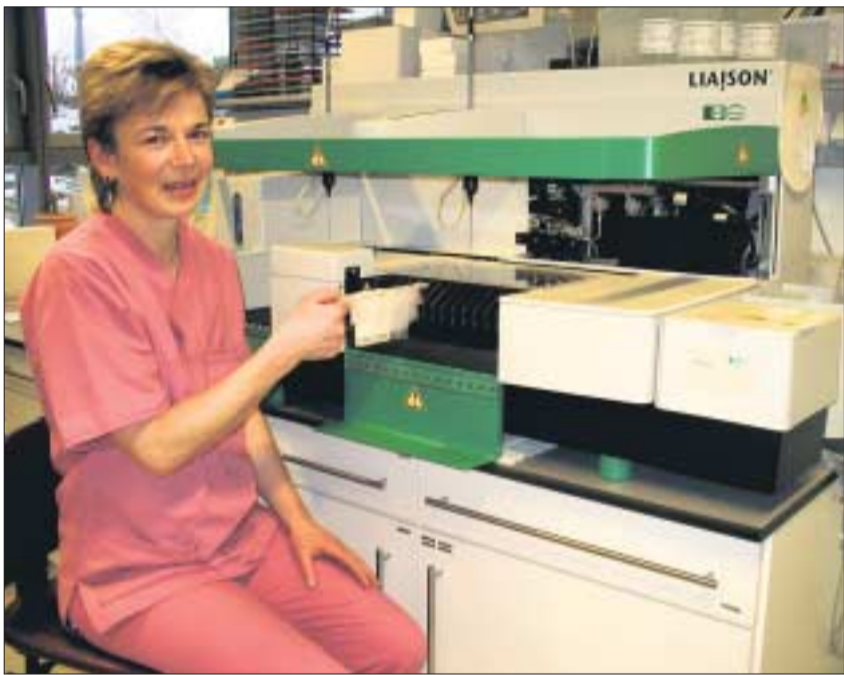
Die Leitende MTA des endokrinologisch-onkologischen Forschungslabors der Klinik und Poliklinik für Gynäkologie und Geburtshilfe des Uniklinikums am immunologischen Vollautomaten des Typs »Liaison«: Mit diesem Gerät lässt sich auf der Basis direkter Lumineszenz-Immunoassays auch das Progesteron im Blut der Elefantenkuh Drumbo nachweisen. Foto: Holger Ostermeyer
