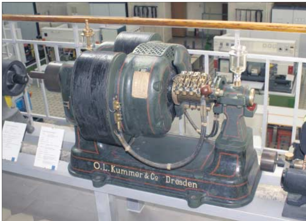
Gleichstromnebenschlussgenerator mit Selbsterregung nach Wheatstone der Firma O.L. Kummer & Co., Dresden-Niedersedlitz.
