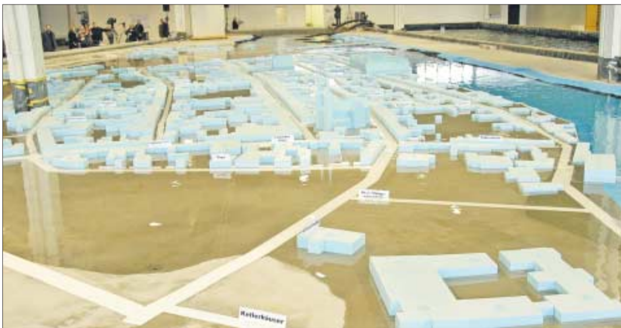
Am nachgebauten Modell von Grimma im Maßstab von 1:50 untersuchen Wissenschaftler der TU Dresden, wie verschiedene Hochwasserstände die Stadt beeinflussen und welche Maßnahmen optimalen Hochwasserschutz bieten. Foto: UJ/Eckold
