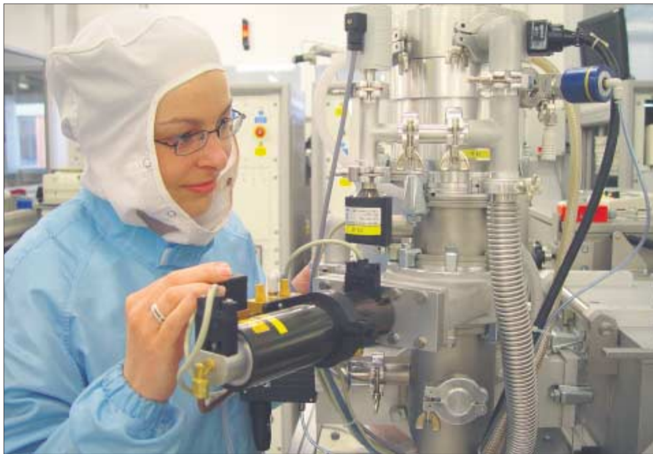
Daniela Schmidt, Doktorandin am Institut für Halbleiter- und Mikrosystemtechnik, prüft den Betrieb der Elektronenstrahlverdampfungsanlage des neuen Reinraumlabor. Fotos (2): UJ/Eckold
