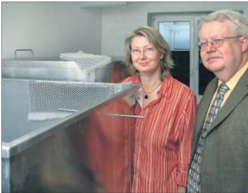
Professor Hartmut Rödel und Dr. Andrea Schenk forschen an metallhaltigen Abstandstextilien für Wassertanks und Duschköpfe. Befestigt an den Wänden von drei Versuchstanks im Institut für Textil- und Bekleidungstechnik soll geprüft werden, ob eine Vermehrung von Legionellen im stehenden warmen Wasser verhindert werden kann.
