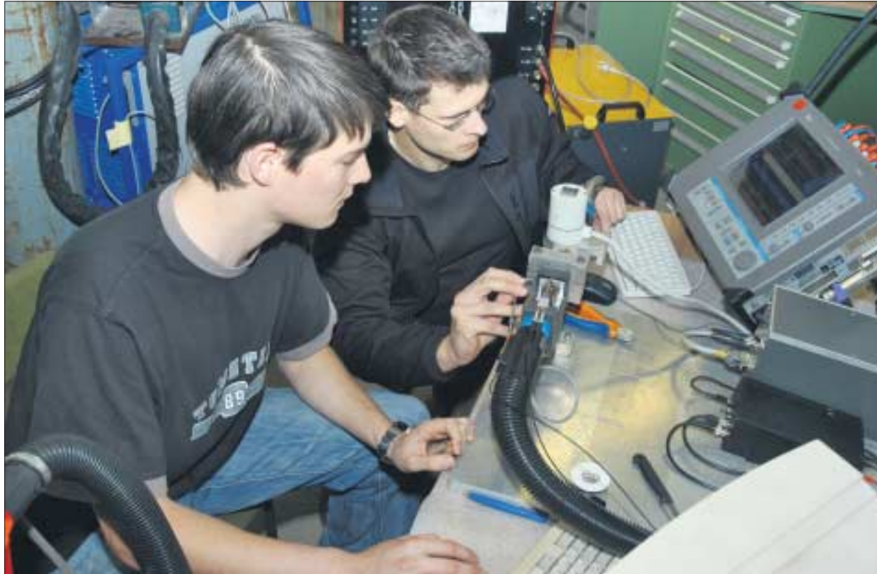
Im Labor für Thermisches Fügen (Zeuner-Bau) messen Niels Goller (r.) und Stephan Götz mittels Drahtsensor die Vorschubgeschwindigkeit beim Schweißen. Eine Recherche im PIZ erbrachte dafür wichtige Anhaltspunkte. Foto: UJ/Eckold
