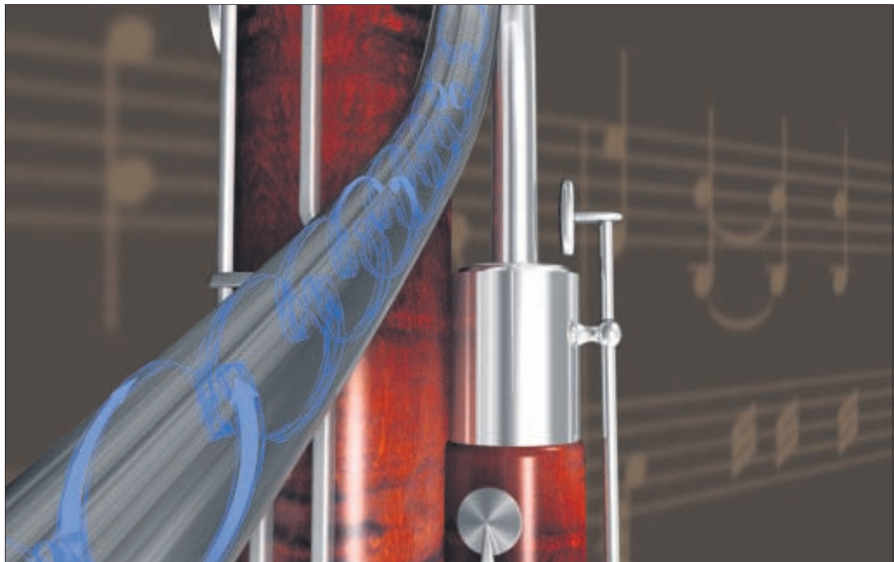
Das Strömungsszenarium zeigt, wie symmetrische Wirbelpaare im klassischen S-Bogen eines Fagotts entstehen.
