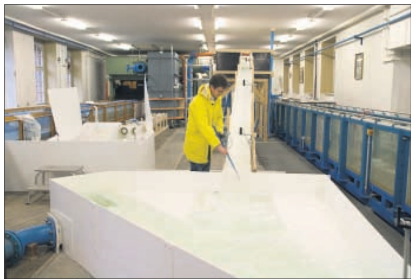
Modell des Hochwasserrückhaltebeckens, das in Niederpöbel entstehen soll. Das Foto zeigt Holger Haufe bei den hydraulischen Untersuchungen. Foto: Archiv uvs
