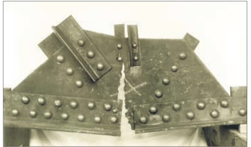
Bruchversuch an einem fehlerhaften Knotenblech, Mechanisch-Technische Versuchsanstalt der TH Dresden (um 1905). Fotos (2): Kustodie TU Dresden
