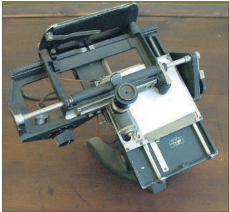
Der Densograph von Zeiss Ikon, ein wissenschaftliches Gerät zur Schwärzungs- und Gradationsmessung, das Emanuel Goldberg maßgeblich mitentwickelte. Fotos (2): Archiv
