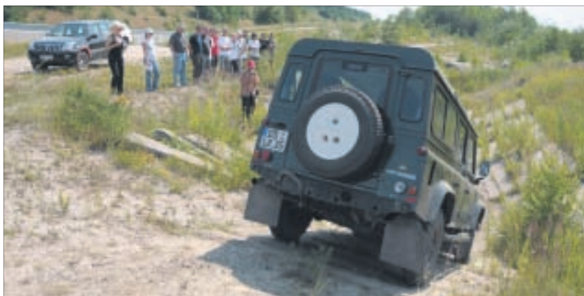
An einem Landrover Defender konnten die Studenten sehen, wie im Gelände das Prinzip der Achsverdrängung für Bodenhaftung sorgt. Foto: MZ/Liebert
