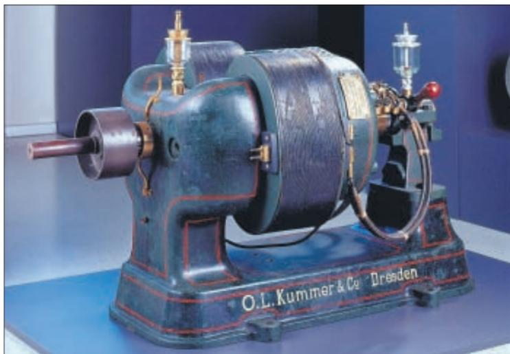
Die älteste noch vorhandene »Kummer-Maschine«, ein von E. G. Fischinger konstruierter Gleichstrom-Nebenschluss-Generator aus dem Jahr 1891, ist in der Sammlung »Historische Elektromaschinen« der TU Dresden im Görges-Bau ausgestellt.
