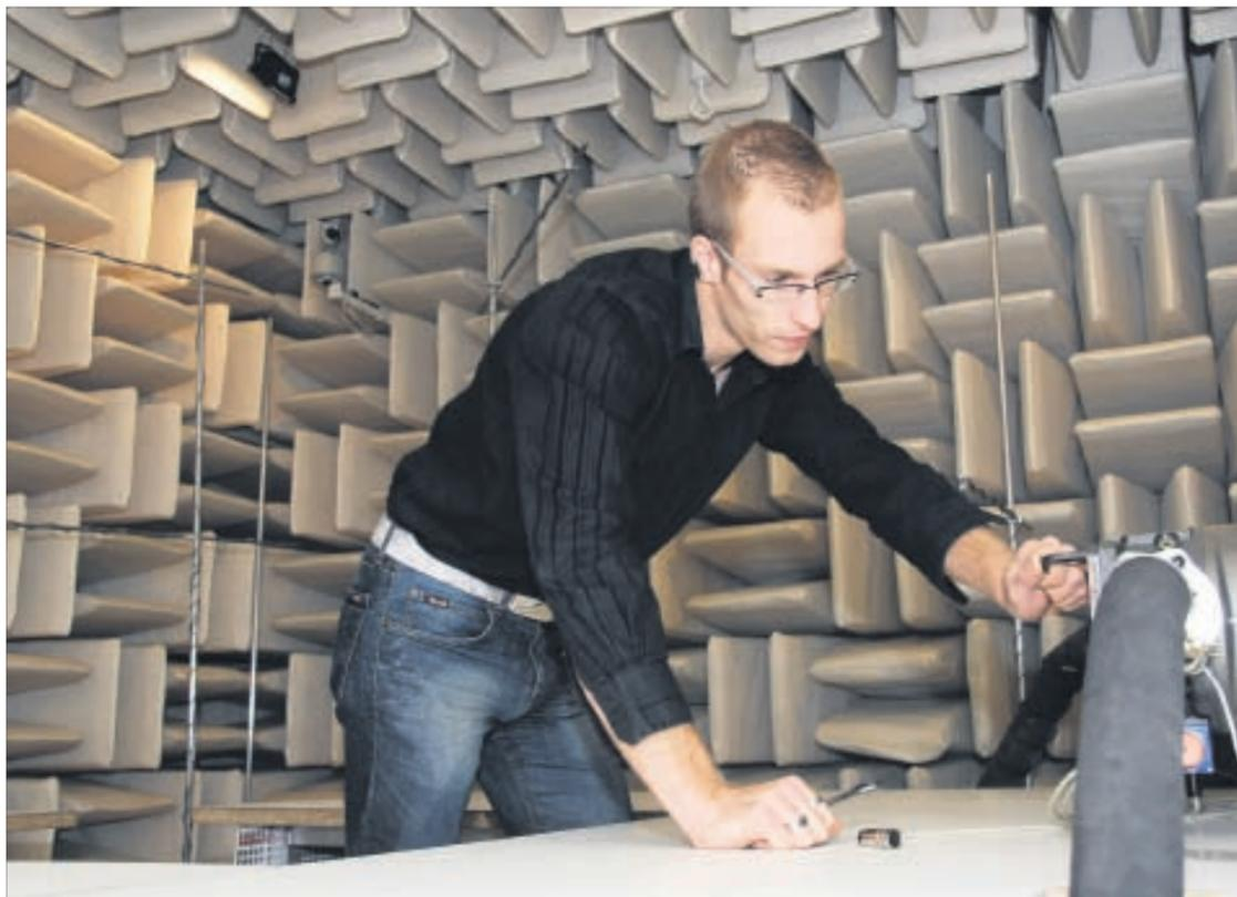
Norman Bügener bereitet im Schallmessraum die Untersuchung einer Axialkolbenpumpe vor.
