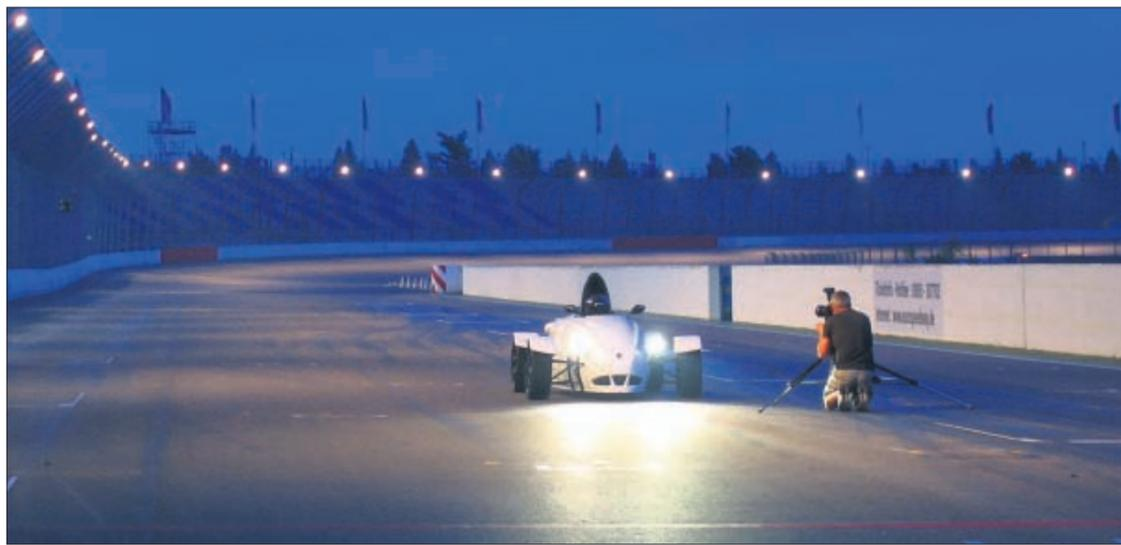
Elektrotrieben, ultraleicht gebaut, von Null auf 100 km/h in weniger als fünf Sekunden und straßentauglich – das sind die Superlative, mit denen der Extremrennwagen e-Wolf E1 bei seiner Weltpremiere auf der IAA begeisterte. Erstmals verbindet dieses an der TU Dresden mitentwickelte Fahrzeug ein Ultraleichtbau-Chassis aus einer Carbon-Aluminium-Konstruktion mit innovati-
