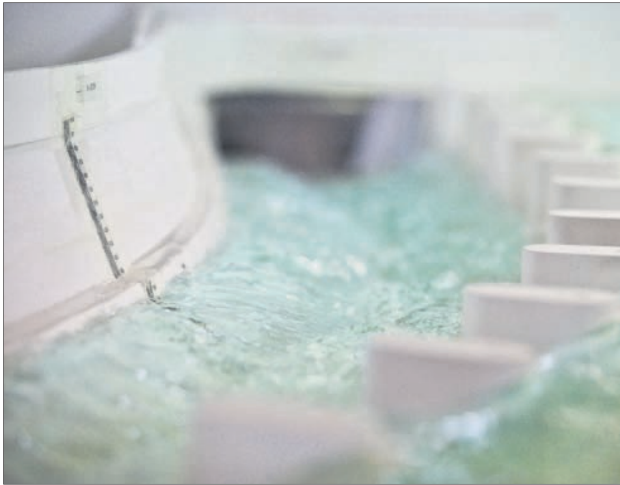
Das Modell eines Teils der Odertalsperre im Hubert-Engels-Labor.
