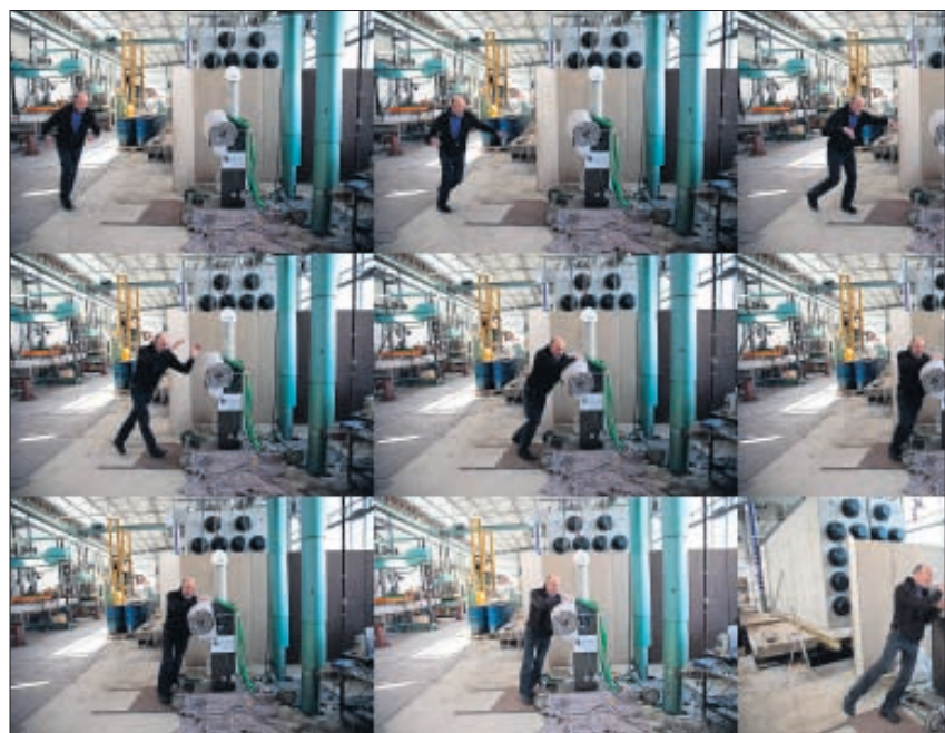
Prof. Peter Ruge wollte es genau wissen und testete im Selbstversuch die Standfestigkeit des Sockel. Der anerkannte Statiker war beim Versuch als Fachberater hinzugezogen worden.
