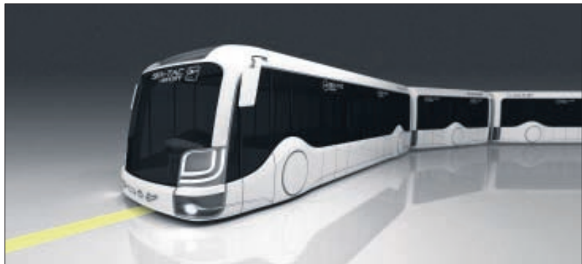
Luftbereifter und bahngeführter Trampus, Entwurf Frank Mühlbauer 2010 für das Fraunhofer IVI. Bilder (2): Archiv Zentrum Technisches Design TU Dresden
