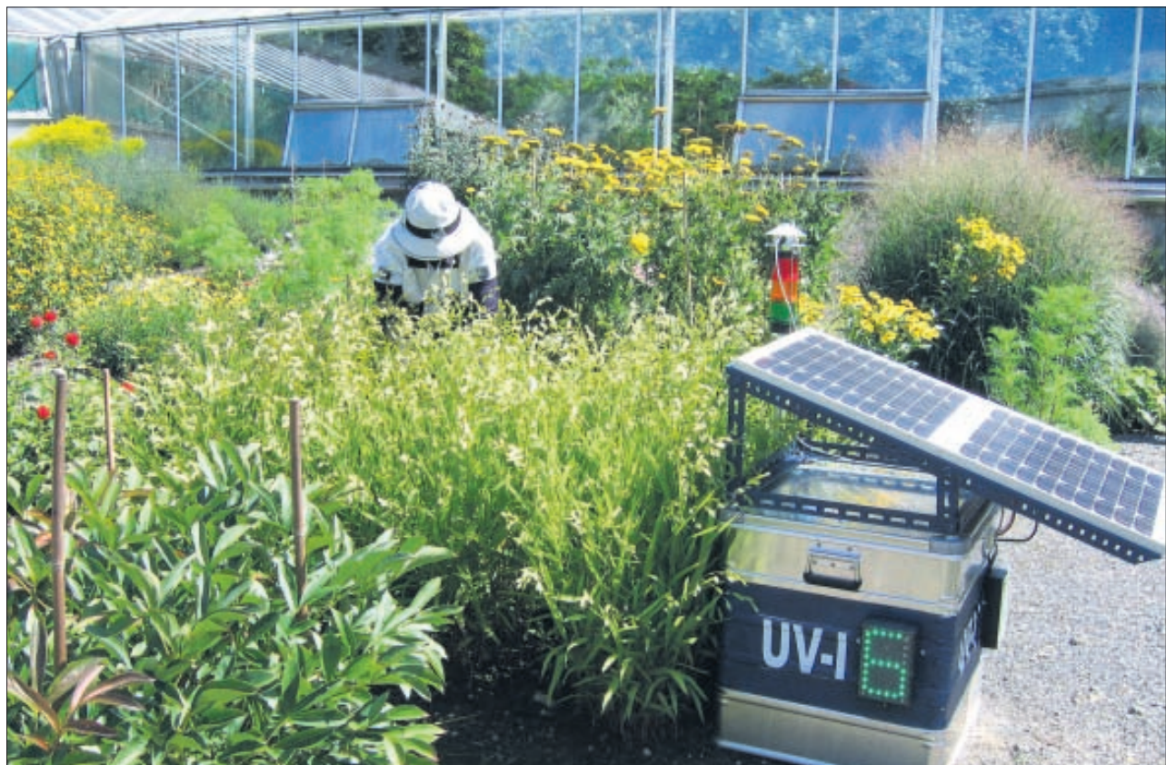
MUVI, das mobile UV-Index-Messgerät zeigt einen Wert von 6 an – hohe Belastung.
