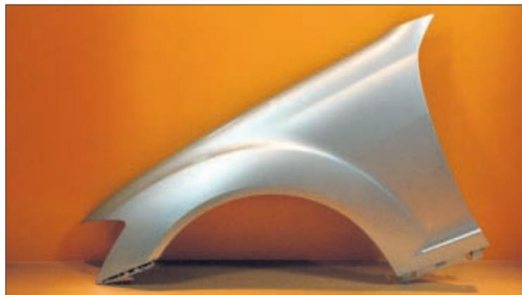
Prototyp eines Karosseriebauteils, basierend auf einem Polymerblend aus Polyamid und Polyphenylenether. Die Verstärkung und Modifizierung mit nanoskaligen Füllstoffen sorgt dafür, dass dieses Bauteil metallische Karosserieanbauteile ersetzen kann.
