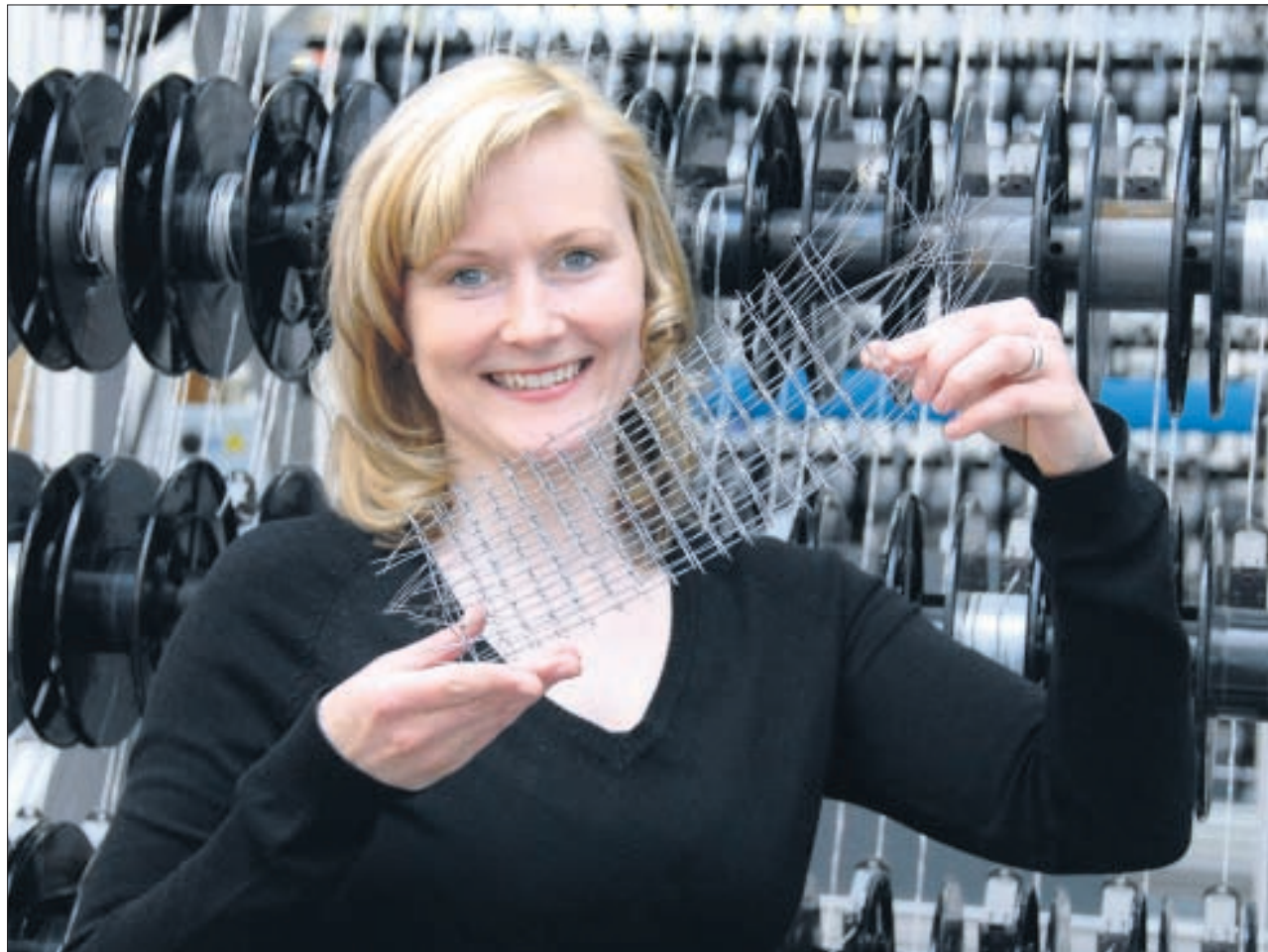
Claudia Kowtsch, wissenschaftliche Mitarbeiterin am Institut für Textilmaschinen und Textile Hochleistungswerkstofftechnik, zeigt eine fertig gewebte dreidimensionale Drahtstruktur. Foto: UJ/Eckold
