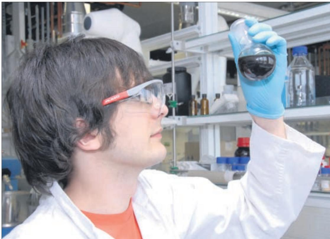
In einem Chemielabor des TUD-Instituts für Anorganische Chemie begutachtet Martin R. Lohe das Ergebnis eines Versuchs, in dem er Nanopartikel aus Siliziumdioxid mit Kupfer beschichtet hat. Der 24-jährige Diplomchemiker arbeitet im Projekt »NanoWearResist« mit, in dem unter anderem Nanopartikel so beschichtet werden, dass sie leichter in Metalle eingebracht werden können. Lesen Sie mehr zu dieser High-Tech-Forschung im Artikel auf Seite 9!
