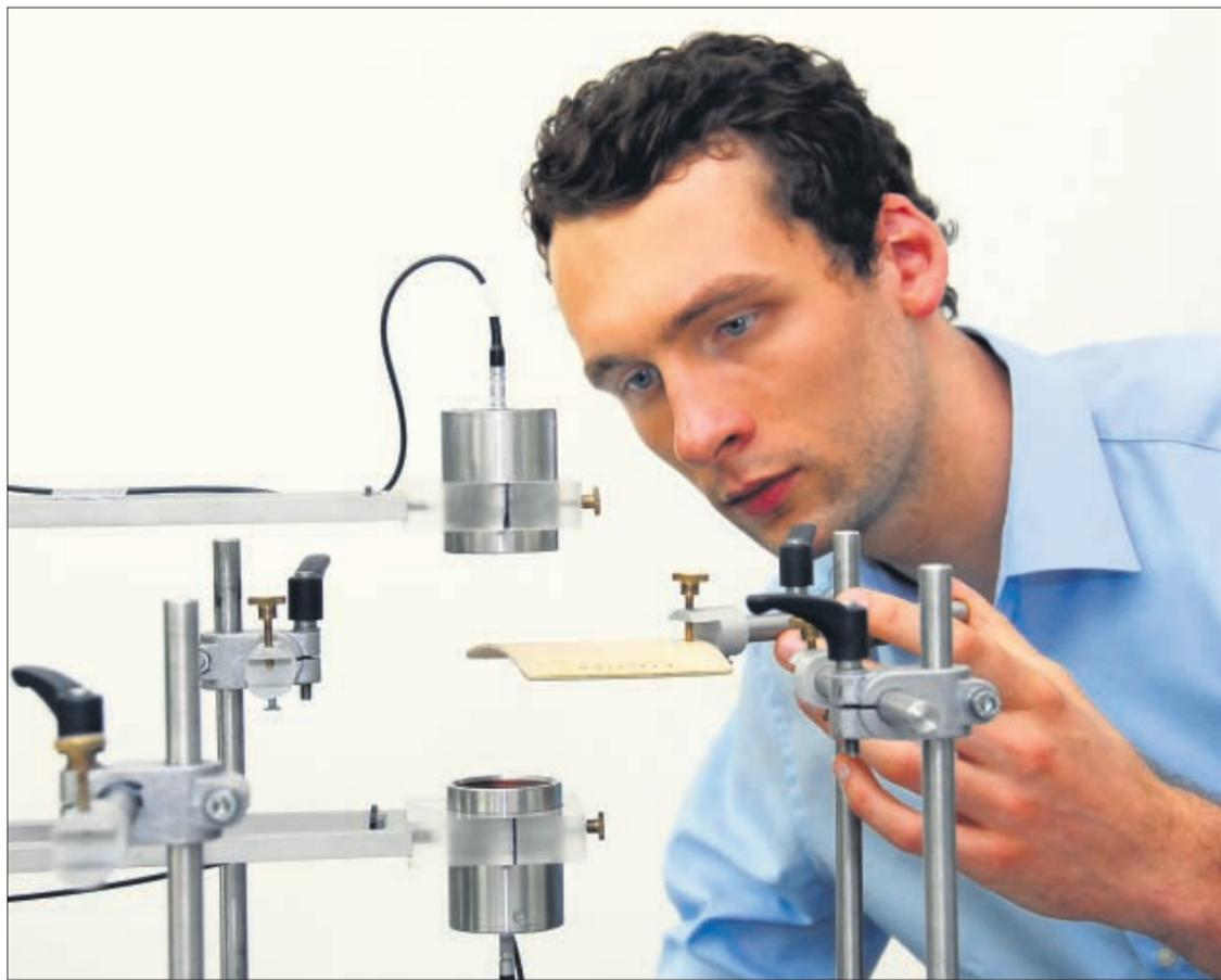
Sebastian Spitzer bei einer Verformungsmessung an einem vielschichtigen Echtholzlaminat aus Fichte.
