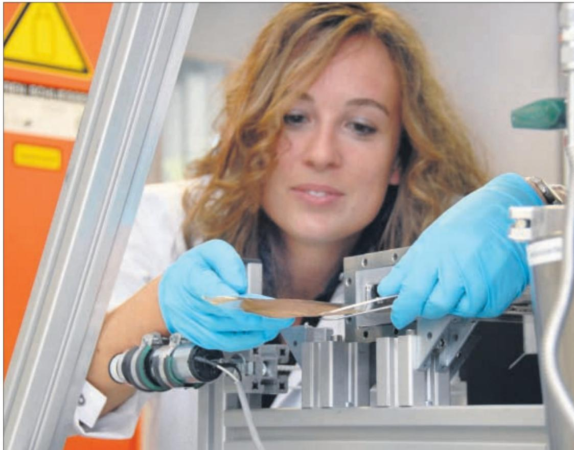
Doktorandin Susanne Dörfler vom Fraunhofer IVS arbeitet an einer Anlage, die es ermöglicht, Substrate wie Nickel und Aluminium mit vertikal orientierten Kohlenstoffnanoröhren zu beschichten. Foto: UJ/Eckold
