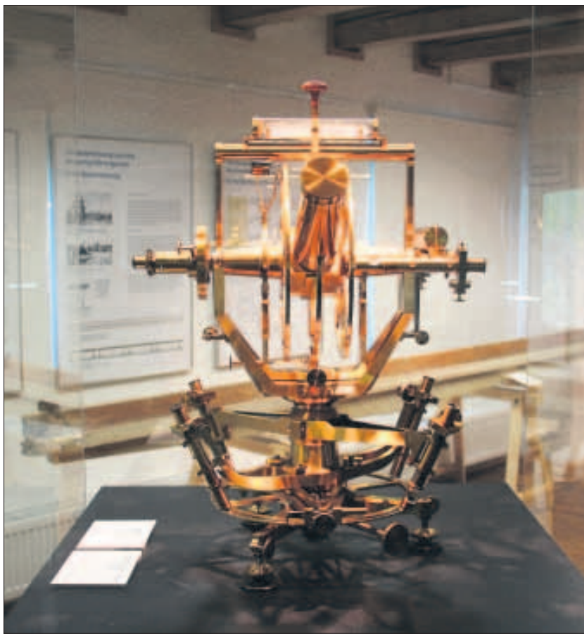
Das Repsoldsche Universalinstrument war maßgeblich an der Gradmessung in Sachsen vor 150 Jahren beteiligt. Foto:TUD-Kustodie
