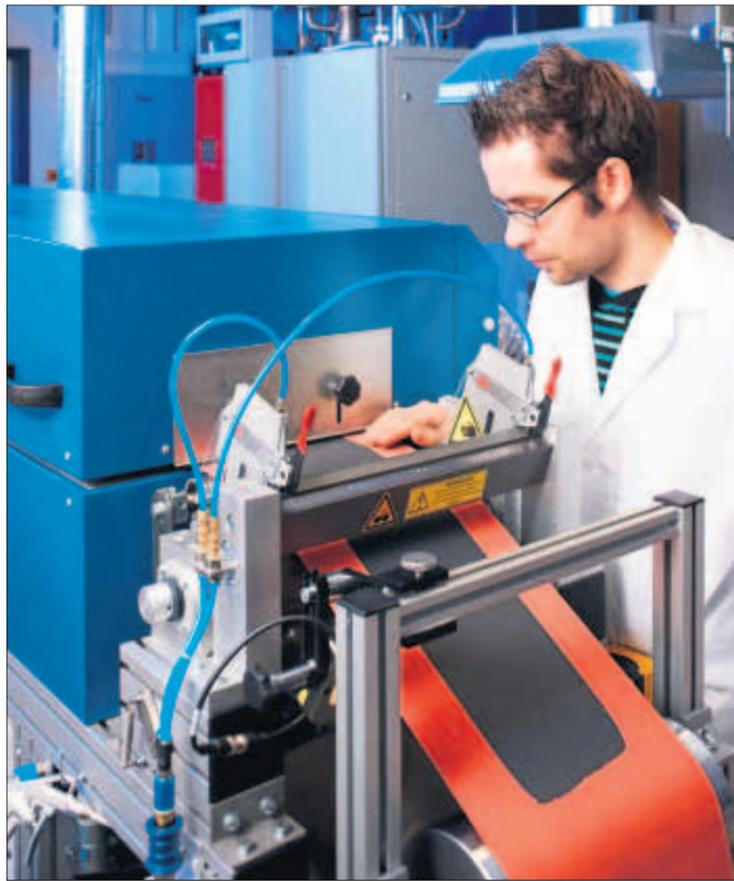
Beschichtung von Elektroden im Rolle-zu-Rolle-Verfahren: Die Forscher haben jetzt das Design von Anode und Kathode für Lithium-Schwefel-Batterien optimiert.
