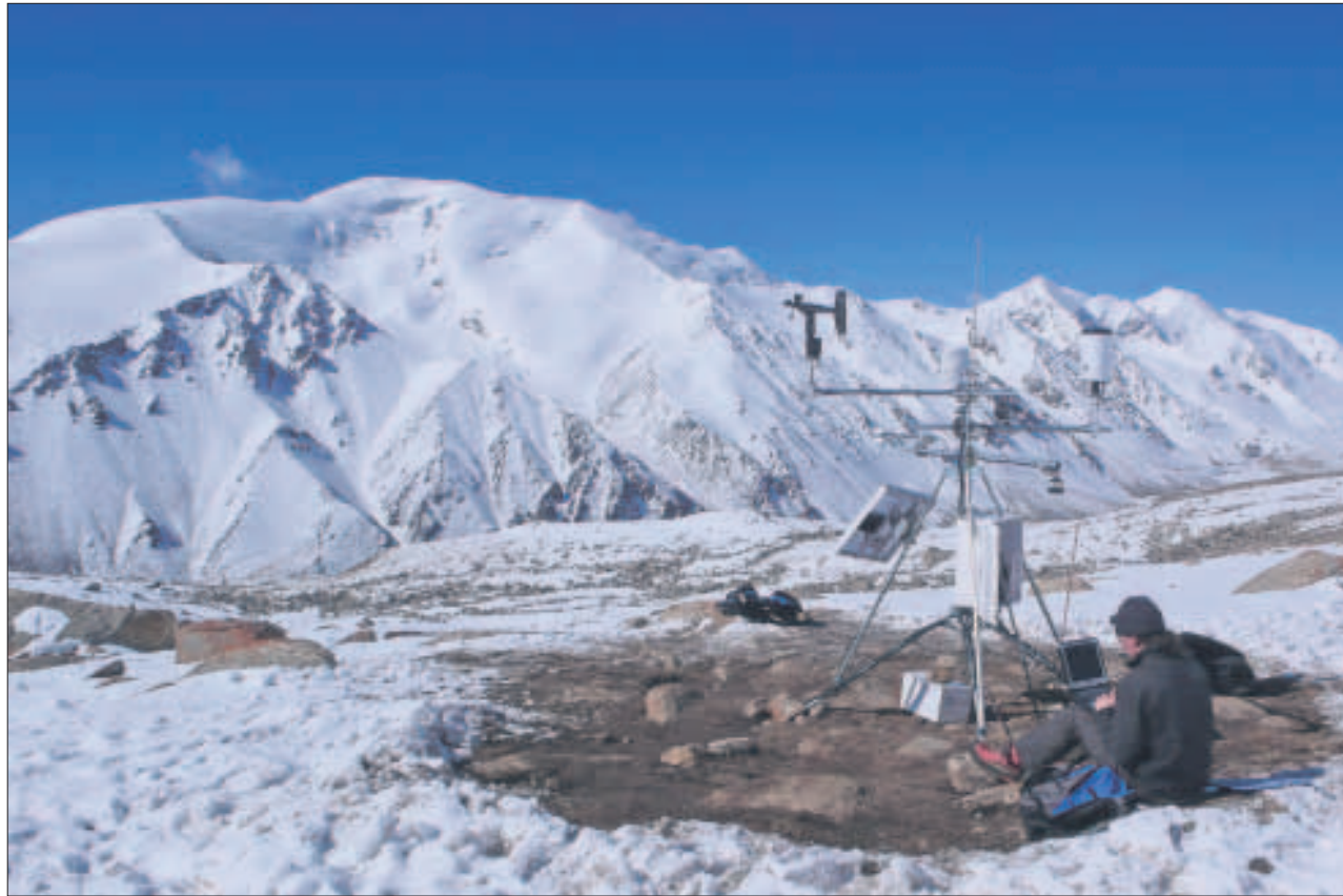
Kartographen der TU Dresden im kirgisischen Teil des Tian-Shan-Hochgebirges: Mithilfe einer hochmodernen automatischen Klimastation beobachten sie, wie sich die Gletscher verändern. Foto: Schröter
