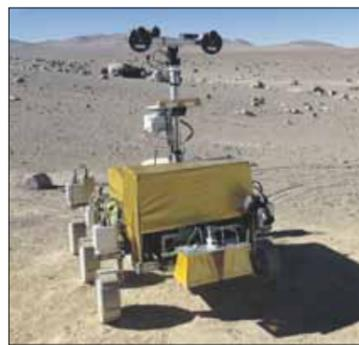
Der Mars-Rover Bridget in der Atacamawüste mit dem Prototypen der Instrumente PANCAM, CLUPI und WISDOM sowie den beiden Antennen des Radars an der Front des Fahrzeugs. Foto: Allouis
