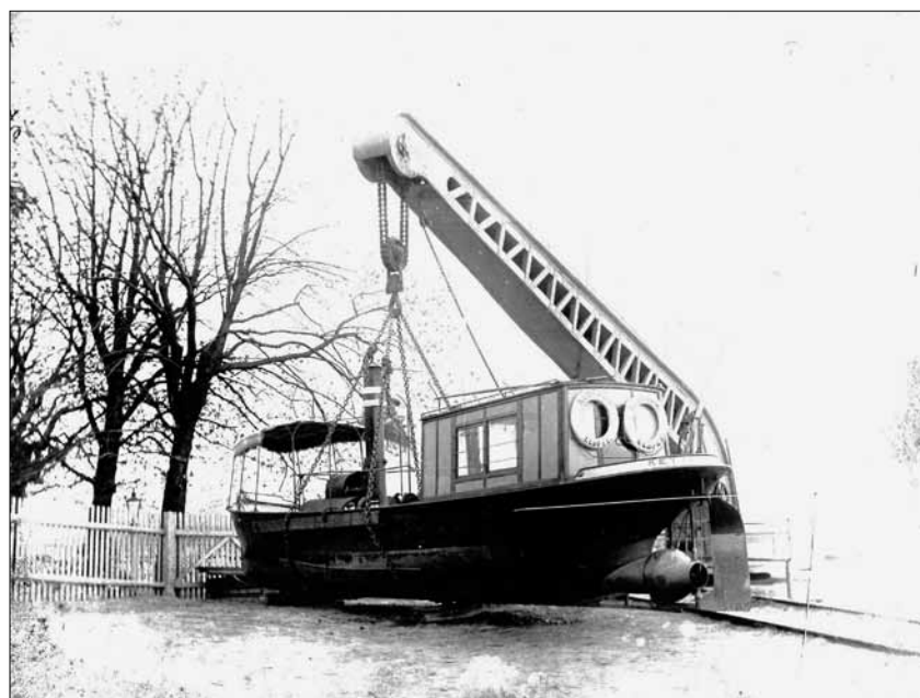
Versuchsschiff »Elbfee« (1891) mit heckseitigem Turbinenpropeller und Kontraktor am Kran von Übigau. Foto: Bildarchiv H. Düntzsch, Riesa
