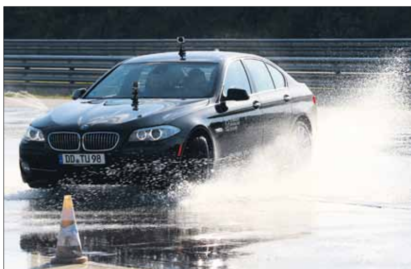
Im BMW 535i der Professur Kraftfahrzeugtechnik erfahren die Studenten die Reaktion eines Fahrzeuges während des Bremsens auf unterschiedlichem Reibbelag (m-split) und abgeschalteten Regelsystemen. Foto: Klonowski
