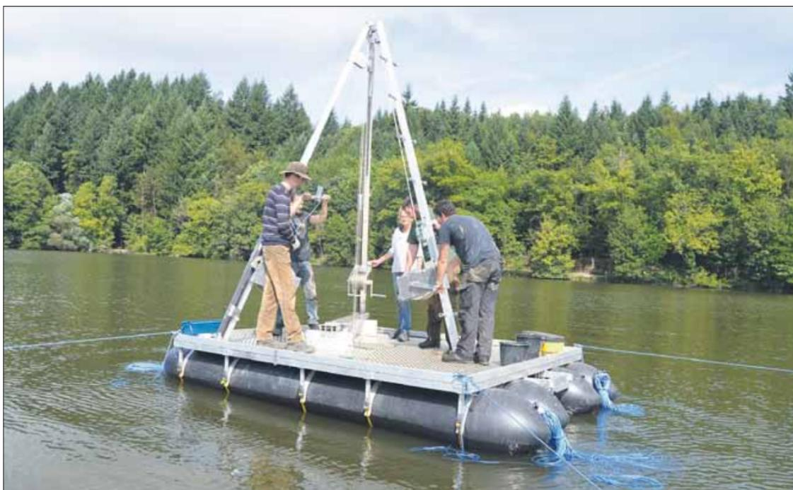
Probenahme auf dem Bergsee bei Bad Säckingen: In der Mitte der zwölf Quadratmeter großen schwimmenden Arbeitsplattform bietet eine Aussparung Platz, durch die ein Stechbohrsystem an die tiefste Stelle des Sees herabgelassen wird. Mittels der zwölf Quadratmeter großen schwimmenden Arbeitsplattform hängenden Gewichten werden spezielle Rohre per Muskelkraft in den weichen Seeboden getrieben. Foto: Lipp
