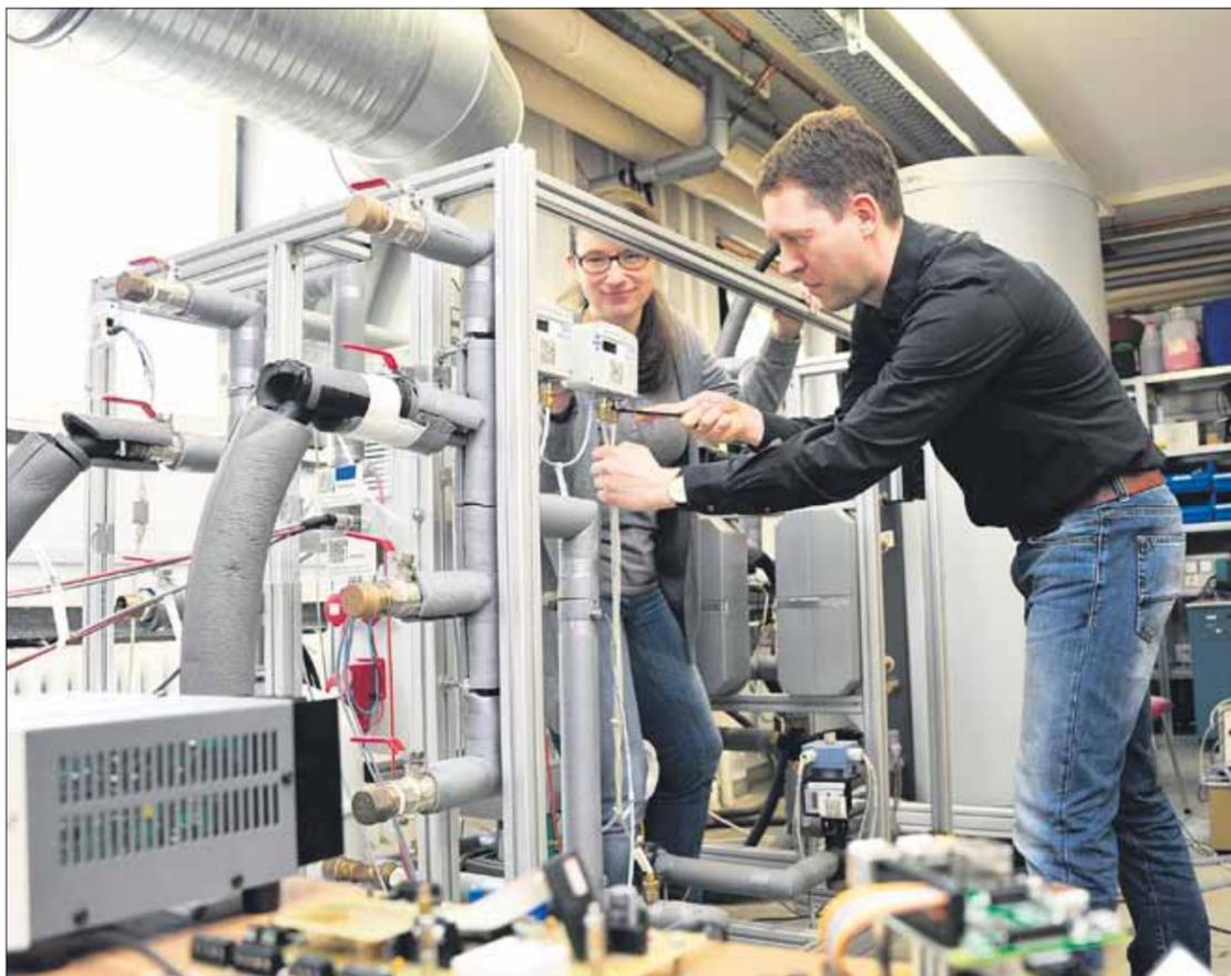
Dr. Joachim Seifert und Andrea Meinzenbach, TUD-Institut für Energietechnik, am Hydraulikbereich eines Versuchsstands im Merkel-Bau. Mit der Technik kann das thermische Verhalten eines Gebäudes modelliert werden. Foto: UJ/Eckold
