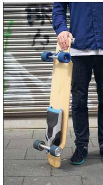
Der Elektromotor lässt sich schnell an das eigene Lieblingsboard schrauben. Foto: Mellow Boards
