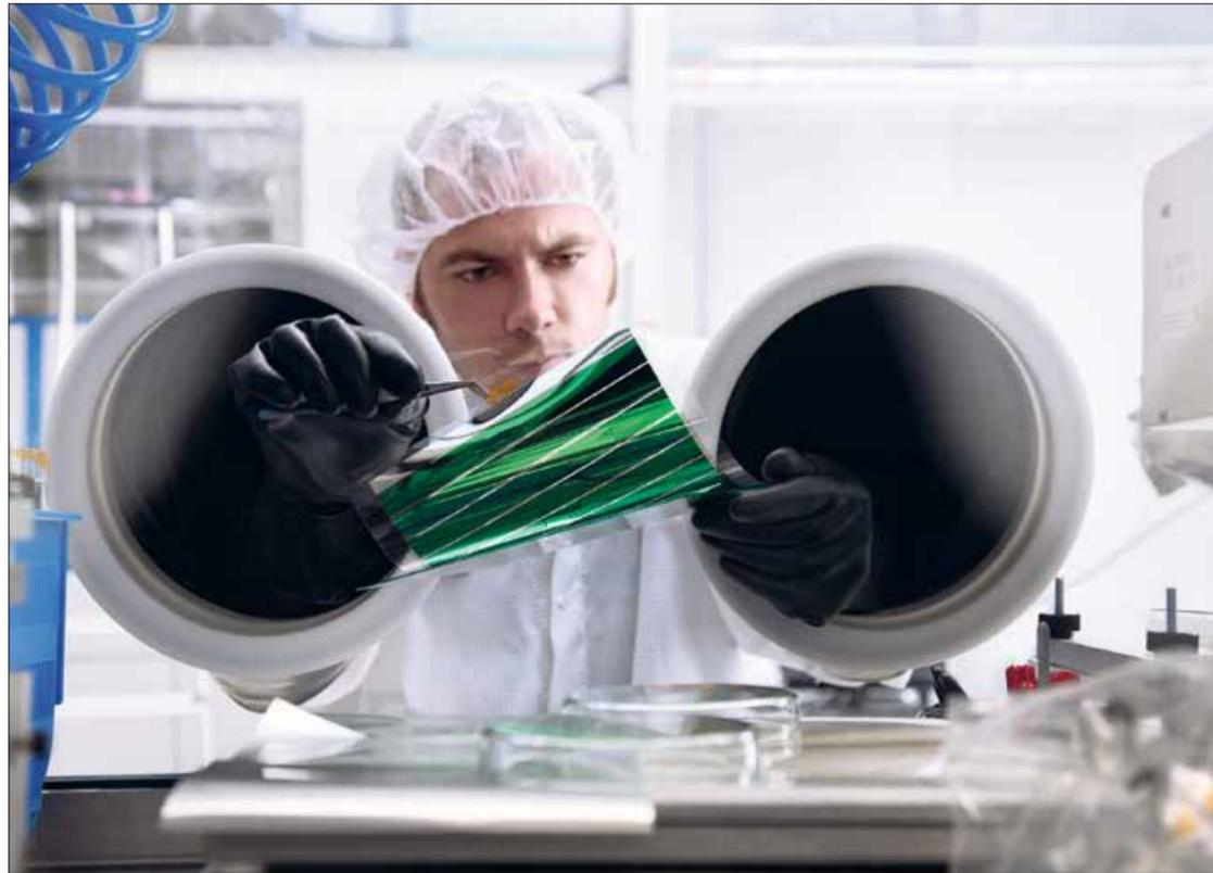
Solarfolie aus dem Labor. Zeigt sich auf den kleinen Glaszellen, dass sich die getesteten Materialien bewähren, werden diese auch für große Solarfolien verwendet und anschließend in die Produktion überführt. Foto: Tom Baerwald
