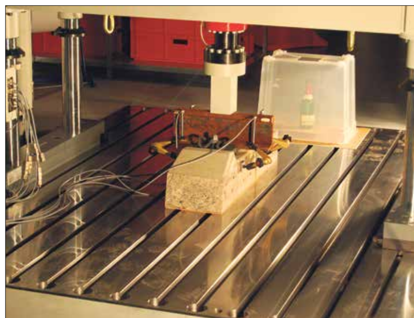
Mit der servohydraulischen Prüfmaschine können nicht nur ICE-Überfahrten mit 200 Kilometer pro Stunde getestet werden. Foto: Andrea Surma
