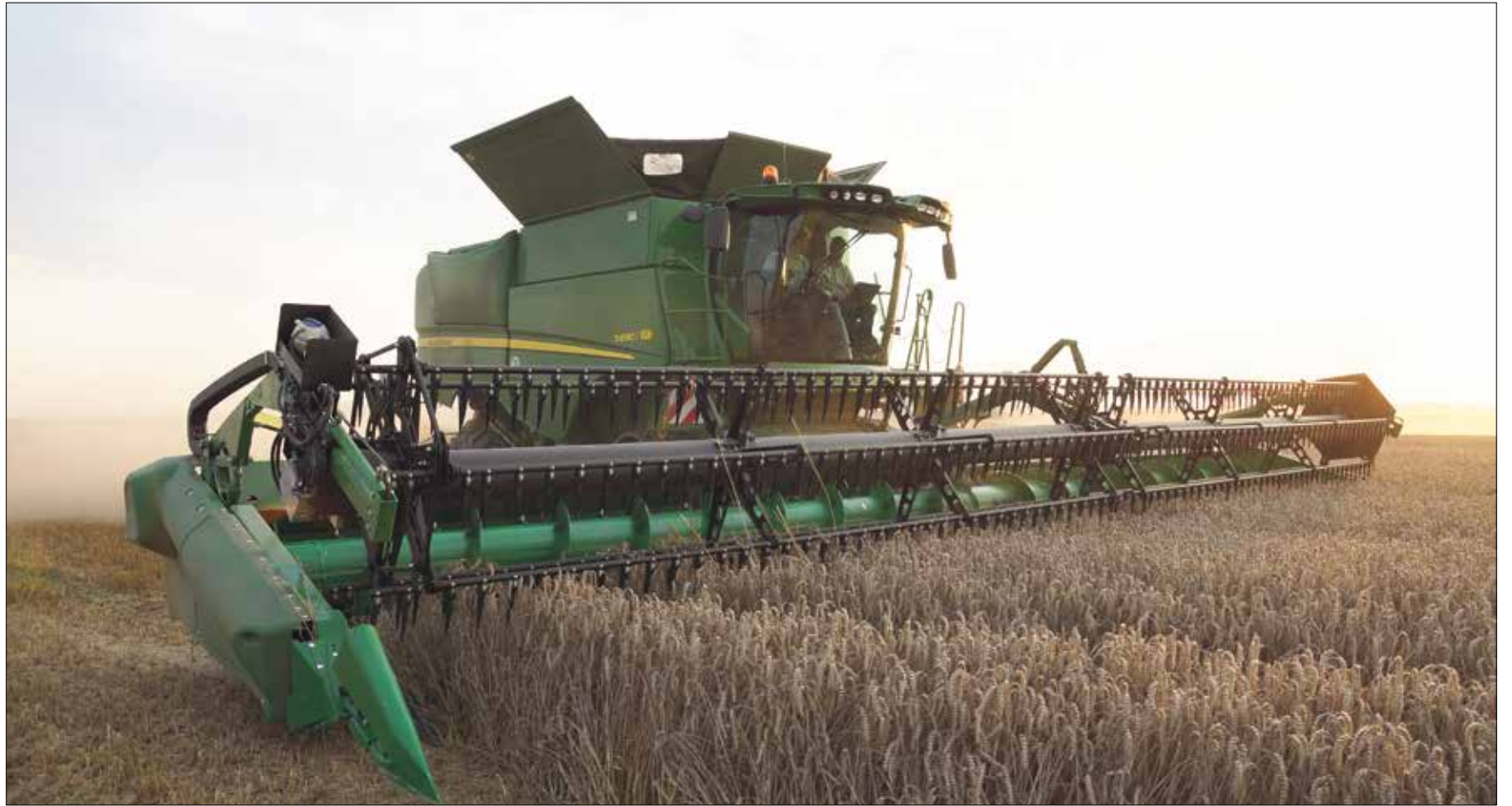
Die Forscher der TU Dresden sind weltweit führend auf dem Gebiet der Elektromobilität in der Landtechnik. Mit dem neuen elektrisch angetriebenen Schneidwerk »Zürn i-Flow« für Mähdrescher werden Ressourcen geschont und die Produktivität der Erntemaschine deutlich gesteigert. Foto: Benjamin Striller/TUD
