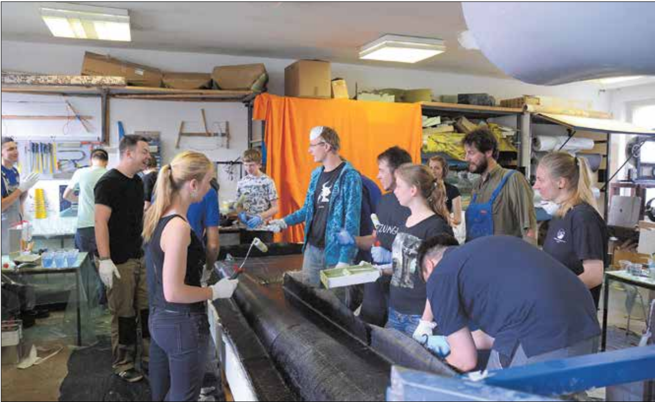
Über zwölf Stunden lang fertigten die Akaflieg-Studenten in einem besonderen Arbeitseinsatz Mitte Mai die Negativformen für den Flugzeugrumpf. Foto: Moritz Heimann
