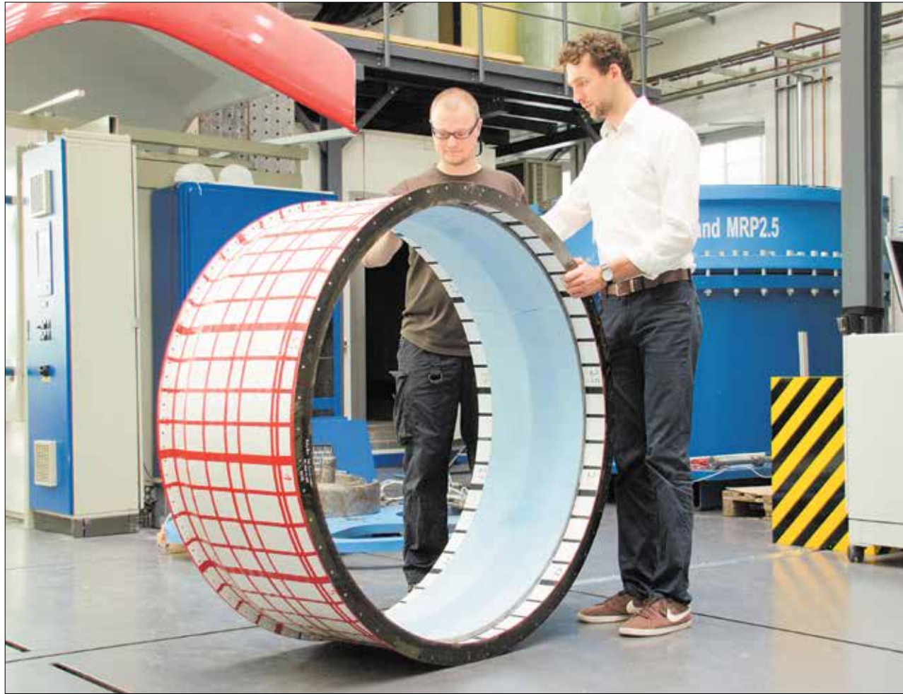
Derzeit laufen am UTC Dresden Validierungsversuche am Berstschutzring aus kohlenstofffaserverstärkten Kunststoffen, der am UTC Dresden entwickelt wurde. Foto: TUD/ILK
