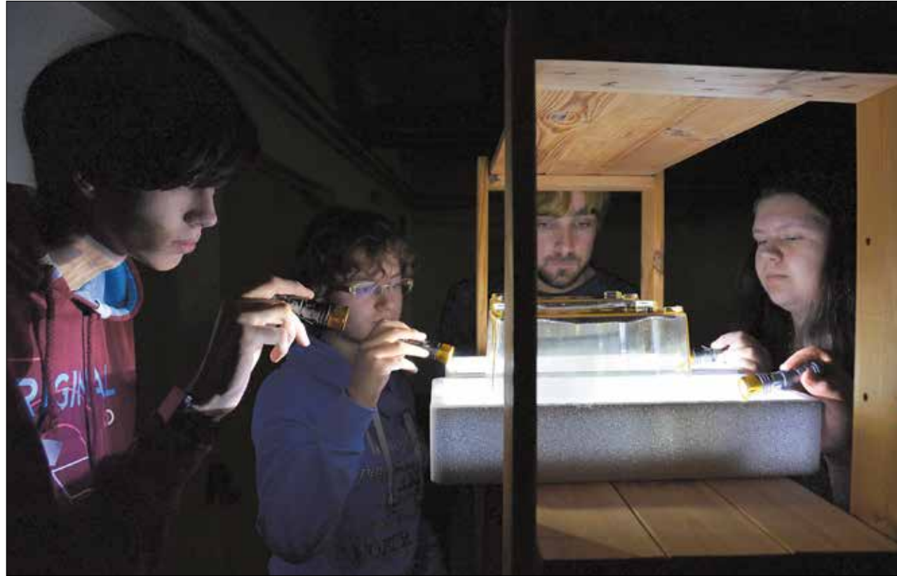
Tom (l.) entdeckt kosmische Strahlung beim Nebelkammerexperiment.
