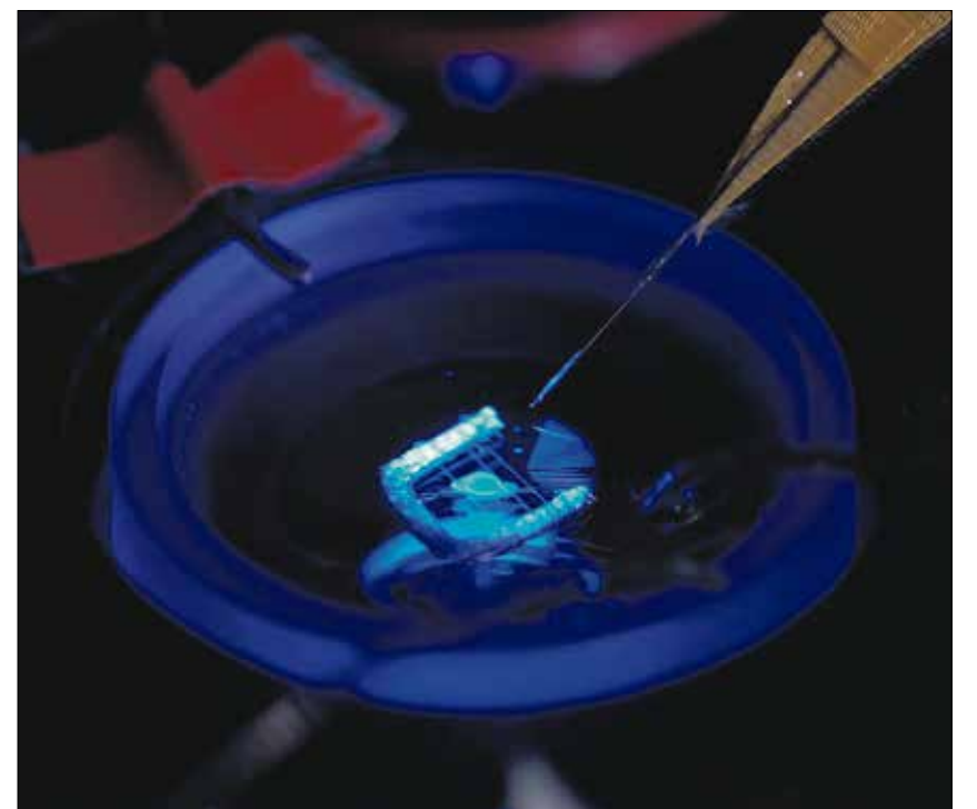
Forschung an einem neuartigen Retina-Implantat basierend auf Organischer Elektronik: Unter dem Mikroskop wird auf einer Test-Retina untersucht, wie das Netzhautgewebe auf die elektrischen Reize der organischen Elektroden reagiert. Foto: WAGNERVISION
