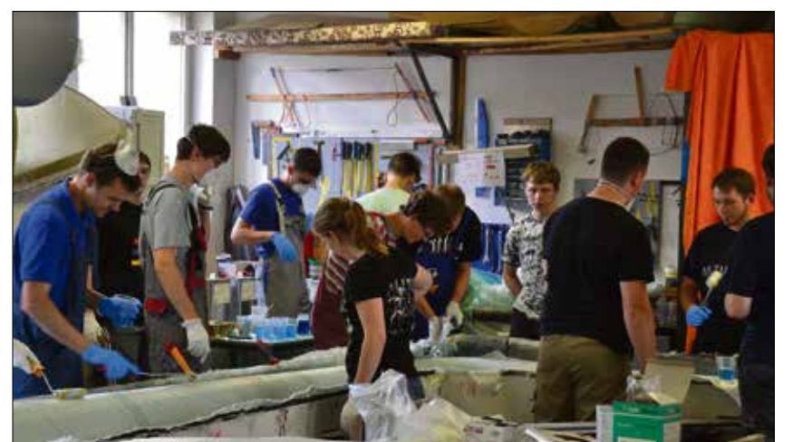
Studenten der Akaflieg Dresden bauen die Hinterrumpfform des Prototypen D-B11.
