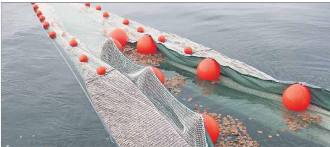
Die ökologischen Ölbinder der Dresdner Ingenieure sind derzeit die einzigen biobasierten, freischwimmenden Ölbinderprodukte, die für eine Ausbringung per Flugzeug und die anschließende Bergung mit Netzsperrern geeignet sind. Die Binder weisen vergleichbare Beschaffungskosten zu den bestehenden Marktprodukten auf, sind durch eine höhere Ölaufnahmekapazität jedoch effizienter. Foto: TUD/Unbehauen
