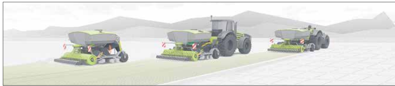
Ein sogenannter Feldschwarm bei der Arbeit. Die kleinen, intelligenten Maschineneinheiten lassen sich flexibel kombinieren und passen sich so perfekt den Umfeldbedingungen an. Visualisierung: Christoph Schreiber, TUD/Technisches Design
