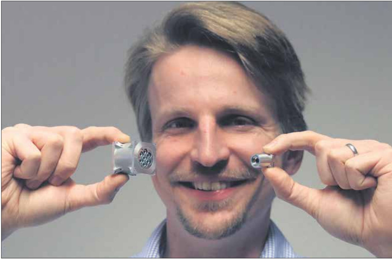
Daniel Bock von »Morpheus« Dresden zeigt die – ursprünglich an der TU Dresden – entwickelten elektrischen Ionen-Triebwerke für Nanosatelliten. Links die etwas größere und stärkere Variante, rechts der Mikroantrieb für besonders kleine Satelliten. Foto: Heiko Weckbrodt
