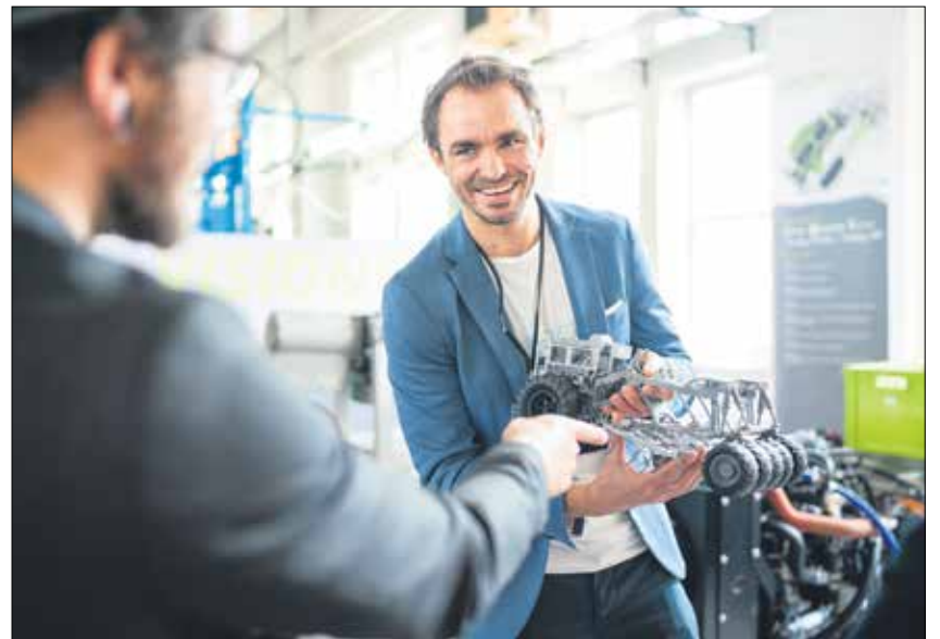
Christoph Schreiber hält ein 3-D-Modell des Feldschwarms in der Hand. Durch einen Wechselrahmen können Werkzeugmodule wie beispielsweise Egge, Pflug oder Grubber unkompliziert und ohne Hilfsmittel ausgetauscht werden. Der Technische Designer und sein Team sind für das Maschinenkonzept, das Design und die Mensch-Maschine-Interaktion des Feldschwarms verantwortlich. Foto: tobiasritz-photography.com
