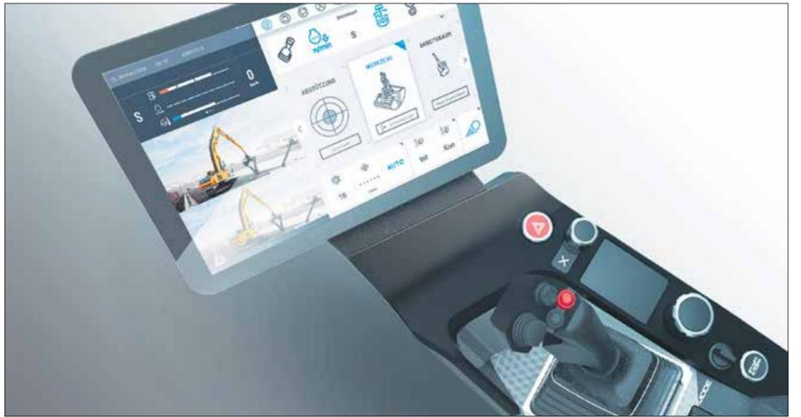
Das große Display-Interface ist das Herzstück der intuitiven Steuerkonsole INTUSI. Abgebildet ist der Arbeits-Modus mit Assistenzfunktionen (Werkzeug, Arbeitsraum, Abstützung, Teilautomatisches Ladespiel und Wiegeeinrichtung) und Schnellzugriffsbereich (obere Zeile). Foto: TUD/Lorenz
