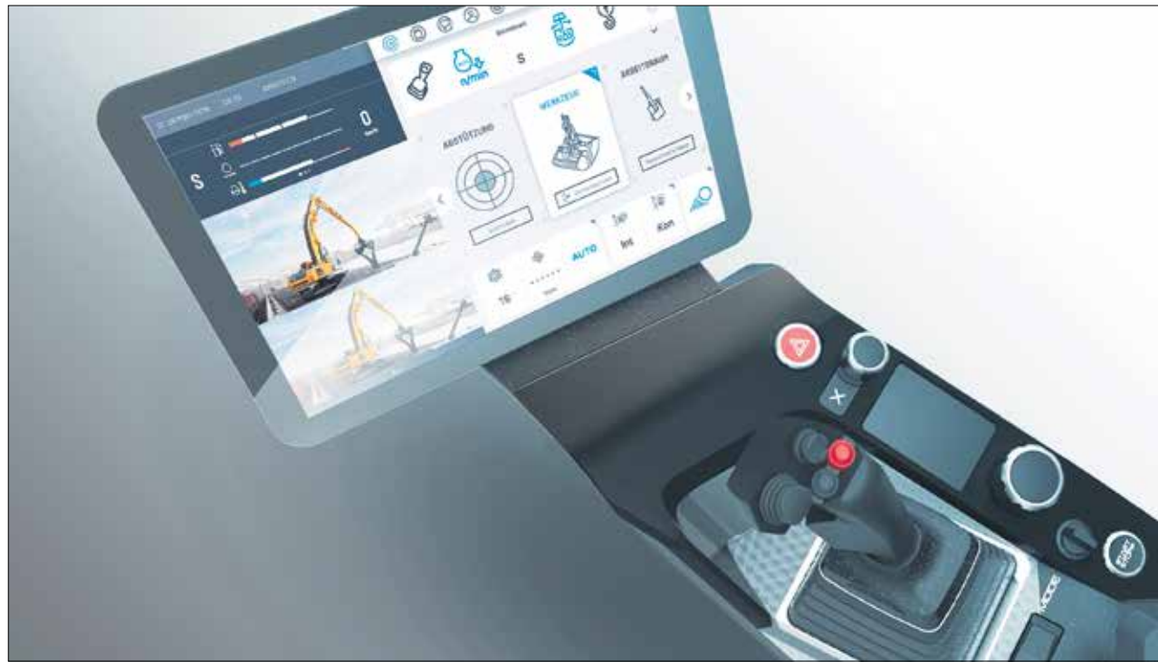
Das große Display-Interface ist das Herzstück der intuitiven Steuerkonsole INTUSI. Abgebildet ist der Arbeits-Modus mit Assistenzfunktionen (Werkzeug, Arbeitsraum, Abstützung, teilautomat. Ladespiel, Wiegeeinrichtung) und Schnellzugriffsbereich (obere Zeile).
