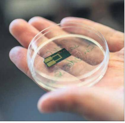
Ein von der Arbeitsgruppe entwickelter Sensor, der Duftmoleküle in der Luft detektieren Foto: Antonie Bierling
