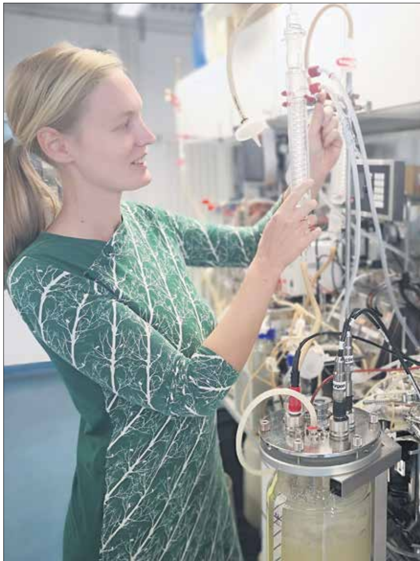
Forscherin Julia Emmermacher überprüft im Institut für Naturstofftechnik der TU Dresden einen Bioreaktor, in dem sie die Ausgangsstoffe für innovative naturnahe Holzschutzmittel züchtet. Foto: Heiko Weckbrodt
