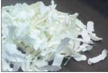
Mit solchen Papierschnipseln wird die Trockenzerfaserungsanlage gefüttert.
