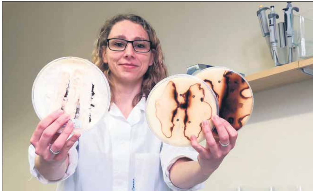
Bioverfahrenstechnikerin Stephanie Stange arbeitet an einem Verfahren, um durch Pilze edle Furnierhölzer mit der »Marmorfäule« zu überziehen. Japanische Designer sind ganz scharf auf solche Furniere. Das TUD-Verfahren soll dabei insbesondere die Holzverluste ohne Chemieeinsatz minimieren. Im Labor klappt das schon.
